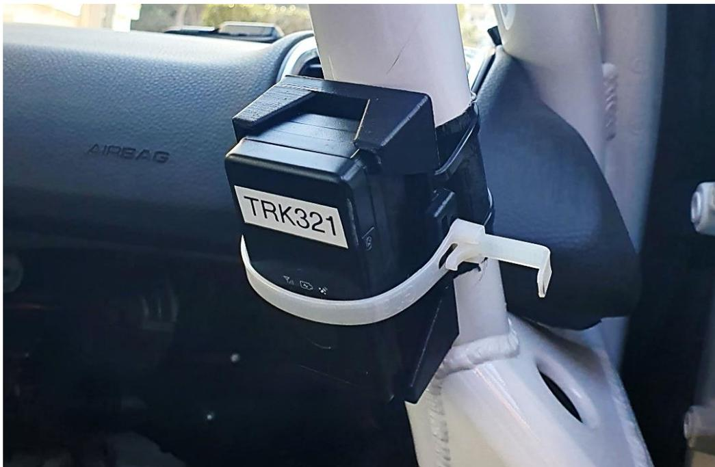
Dispositivo GPS montado en el soporte fijado a la barra antivuelco frente al copiloto mediante el uso de bridas.
